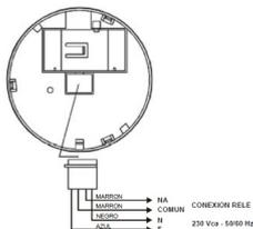
Con cada detector se suministra un conector con un cable azul, otro negro y dos marrones. Conectar el cable azul con una fase 230Vca. Conectar el cable negro con el neutro 230Vca. Los cables marrones son la conexión con el relé de salida NA: normalmente abierto.
